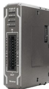
IR-PU01-P permet le contrôle de mouvement avec un axe. Ce nouveau module de contrôle fonctionne avec les coupleurs de communication existants dans la gamme cMT-Series ainsi que le Contrôleur Automate/Passerelle IoT cMT-CTRL01 pour contrôler les moteurs pas à pas et servomoteurs.
