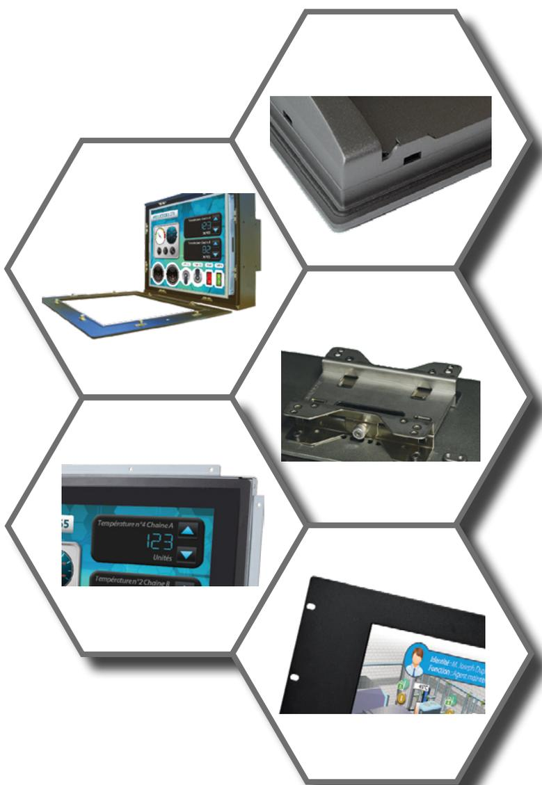
Le montage **«Encastrable»** laisse apparaître la zone d'affichage et le cadre de l'écran.
