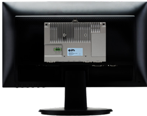
Fixation VESA pour transformer votre PCSL1630AD en Panel PC Exemple de Fixation sur Écran Standard (Système VESA)
